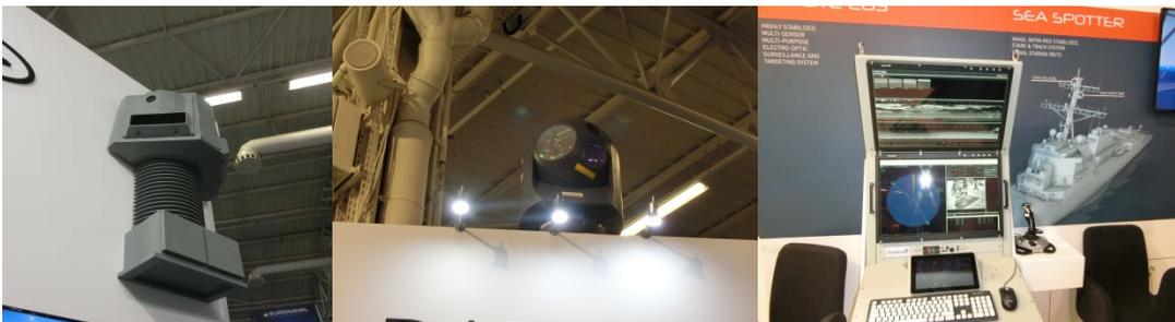
(写真は左から IRST、EO センサー、そのオペレーターコンソール、これらで Sea Spotter という名前の Naval Infrared Stabilized Stare and Track Passive Early Warning System を構成しています。)
