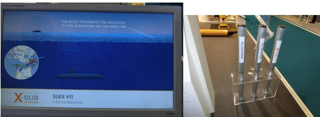
(写真は ALSEAMAR 社の潜水艦通信ブイの機能図 (左) とブイ本体 (右))
