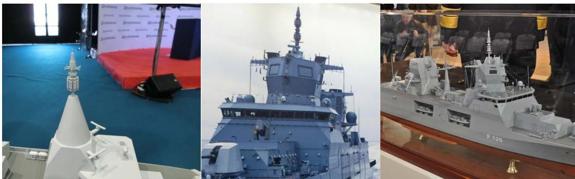
上の写真左はドイツ海軍 GPC 90 のマストで、最上部が ESM、その下の俵型の巻物が V/U 通信アンテナ。このマスト形状は F222（中）及び F125（右）にも適用されています。
