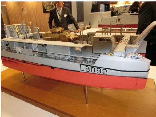
同揚陸艇は船底が持ち上がり、水面上に出ることにより、航走時はカタマラン（双胴）による高速（ウォータージェット推進）走行が可能です。船底が持ち上がっていますので、岸壁への揚陸が可能であり、不整地への着岸も可能となっています。南西諸島への事前展開には島の港への着岸揚陸に効果を発揮するのではないかと思います。
