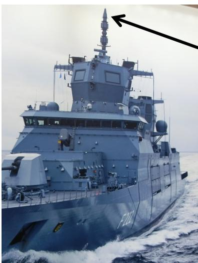
写真左：Rohde & Schwartz 社の ESM アンテナ (F-222 のトップに装備されている三角錐形のアンテナ)
