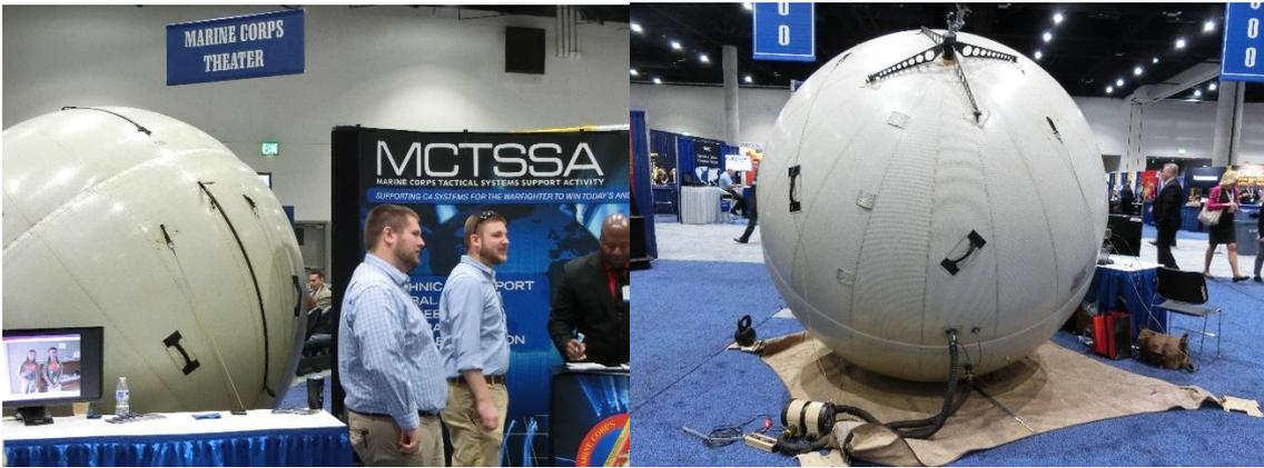
写真は海兵隊戦術システム支援隊（MCTSSA）のブースに展示されていたGATR（現在はCUBIC傘下の企業）の携帯型（風船式）衛星通信アンテナです。右の写真は空気ポンプもそのまま付いているので構成が良く分かります。展示品は2.4mアンテナですが、1.2m～4.0mまで大きさが揃っています。持ち運びはペリカンケースであり、アンテナ（球体）は防弾仕様になっています。組み立てから通信可能状態まで約30分と短く、陸軍・海兵隊でよく使われています。YouTubeで組み立てから防弾の証明までをビデオで見ることが出来ます。
