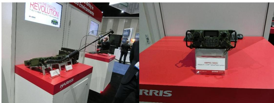
左は AN/PRC-117G と付属アンテナであり、SDR 通信機（音声・データ）として米陸軍・海兵隊の現在の主力個人装備通信機（UHF IP）です。MUOS (Mobile User Objective System: 個人の端末から衛星を通じて同じ個人の端末への自由な通信を可能とするものであり、陸軍・海兵隊・海軍用に SPAWAR がプロジェクトを率いています。) 対応のハードウェアを装備した 117G は、衛星通信 (SATCOM) の音声とデータの同時伝送能力を備えた BLOS (Beyond-Line-Of-Sight) 通信が可能だということです。右は AN/PRC-160 であり、Manpack の HF/VHF IP 通信機で、現在の世界標準仕様である 120kbps を満足し、衛星通信 (SATCOM) が使えない状況下の遠距離 (BLOS) 通信（音声・データ通信）として米陸軍・海兵隊の主力通信機となっています。
