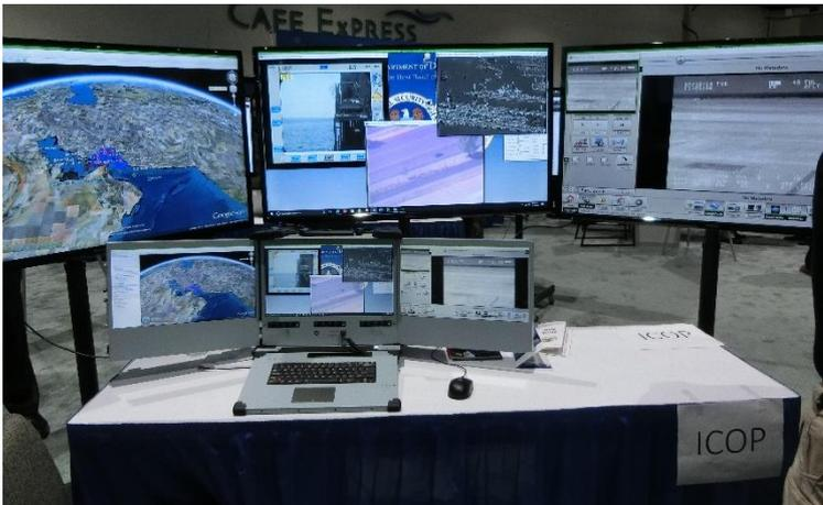
機器は写真の机の上にある 3 面のモニターとキーボード、中央モニターの裏がコンピュータとデータストレージになっています。また、持ち運び時には折り畳んで一つのケースに入る構造になっています。
