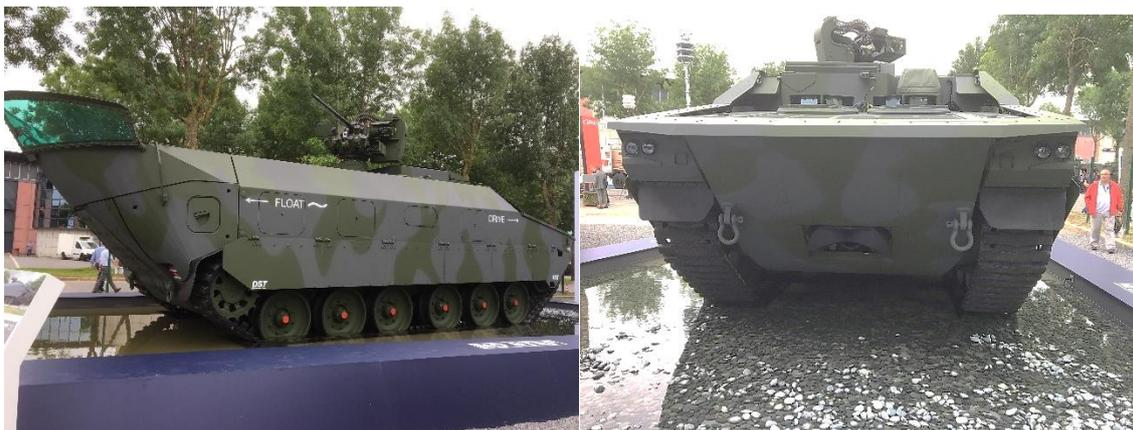
写真はドイツの KMW 社の水陸両用の装甲車 APVT で、水上走行時は後ろ向き（左側）に進むもので、前方にウォータージェットが装備されています。正面の攻撃に耐える装甲形状と水上走行は水切りを付けた後ろへという発想の転換が面白い製品と感じました。
