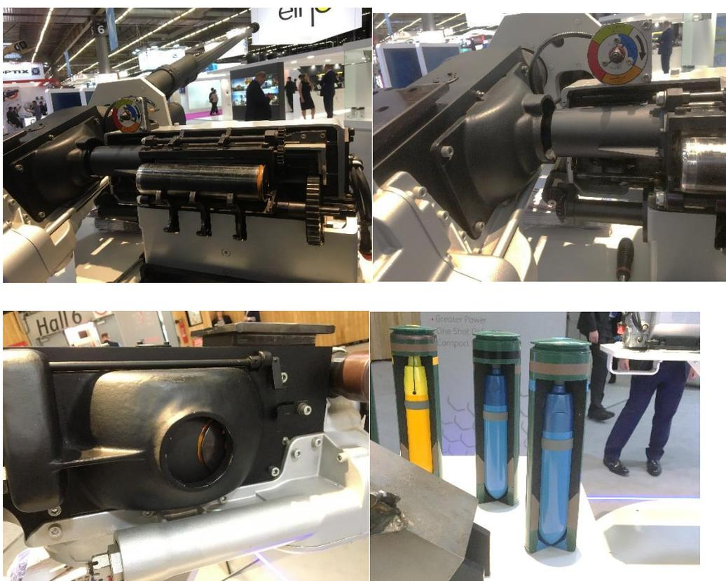
写真は BAE Systems 社の 40mm CASED TELESCOPED ARMAMENT SYSTEM です。同社はボフォース 40mm 3P 弾システムも保有しているのですが、この 40mm は給弾機構に特徴があります。フランス陸軍に 500 門、英国陸軍に 300 門納入し、現在フランス海軍向けに交渉中とのことです。
