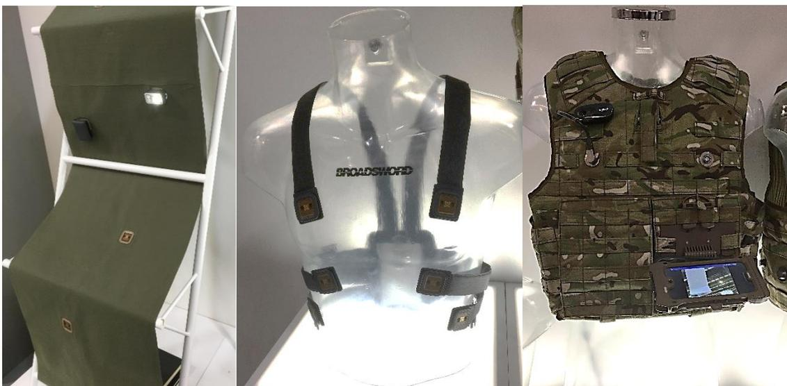
上の写真は同じくBAE Systems社の電導性のある生地で給電する防弾ジャケットです。生地そのものが電気を通すので、それを中央の写真のようにして、背中に給電コントローラーを付け側面と正面に電極端末を配置するようにした右写真のジャケットの裏側を見せられている状況です。中央の導電帯が全て切断されない限り給電されるので、残存性を高められることに繋がり、電線を沢山這わせなくて済むことが出来、様々な装備品の装着や銃などの武器の携行を容易にしています。
