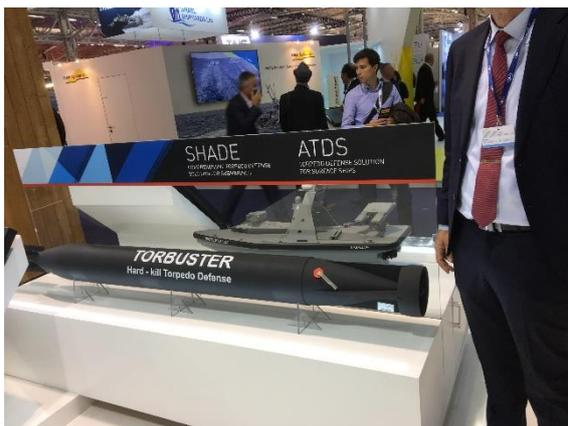
写真左は RAFAEL 社の TORBUSTER という潜水艦用の Torpedo Counter Measure ですが、欺瞞するのではなく、引き寄せられた魚雷を自らが爆発することで破壊するものです。また、欺瞞するだけの SCUTTER という Counter Measure もあるそうです。どちらも、射出体内に魚雷データベースを持ち、探知した魚雷のソーナー音響からその魚雷を割り出して適切な欺瞞を行うという説明でした。
