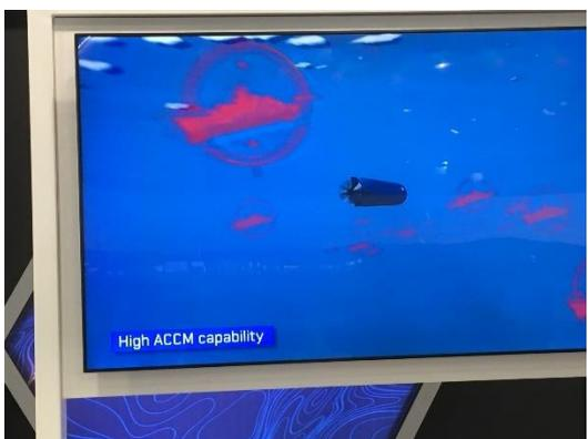
上写真は NAVAL GROUP が主契約者である Heavy Weight Torpedo F21 のカット模型及び実物大模型、並びに同グループで上映されていた動画の写真です。発射は Swim out または Water push が選択でき、電池推進で最大速度 50Kt（最大速度は 20 分間継続可能）、航走時間は最大 1 時間、高度なソーナー処理技術と TCCM 回避能力を持つと謳われている。既に 100 本以上が生産され、フランス海軍とブラジル海軍に納入されています。
