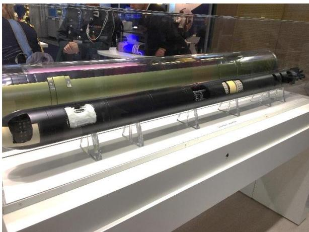
左写真は ATLAS ELEKTRONIK 社ブースに展示の Heavy Weight Torpedo SeaHake mod4 ER のカット模型です。ER と名が付いているのは Extend Range (射程延伸) モデルです。このモデルは射出後にターゲットデータを受信できるように受信アンテナを中部に備え、それにより航走距離を 140km/75nm まで延伸した攻撃 (潜水艦発射、水上艦発射、陸上基地発射) が可能なようになっています。
