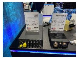
写真は GMS 社のコンタクトクーリング型の GPGPU サーバーとスイッチです。コンタクトクーリング (接触冷却) は戦闘車両等に搭載されることが多いものです。
