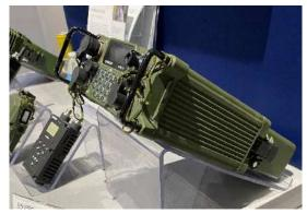
写真は AN/PRC-160 という Wideband HF/VHF 戦術通信機です。周波数範囲は  $1.5\sim60$ MHz、HF で 20Watts、VHF で 10Watts の出力、 3kHz $\sim24$ kHz のバンド幅で 120kbps のデータ通信能力を有しています。また、NSA が認証した暗号機能が実装されており、米国の Top Secret 秘密区分の通信も可能とされています。海兵隊ブースで話した隊員は間もなくこの AN/PRC-160 が実際に配備されることに期待していると言っていました。
