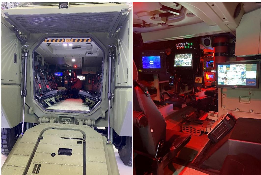
写真は BMC 社の兵員輸送車の内部の様子。RWS の操作パネルとジョイスティックがあり、車体に取り付けられた EO センサーによって外周の様子が画像によって良く確認できます。RSW 操作の兵士が 1 名、後方に着席した兵士が 9 名、車長とドライバー、計 12 名が乗車できます。
