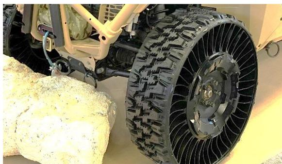
左写真はミシュランのパンクしないタイヤ (空気で膨らませるのではない構造) を履かせたバギーです。タイヤの構造が良く分かります。これでパンクに対応するための予備タイヤなどのパーツを減らす効果もあるものと思われます。
