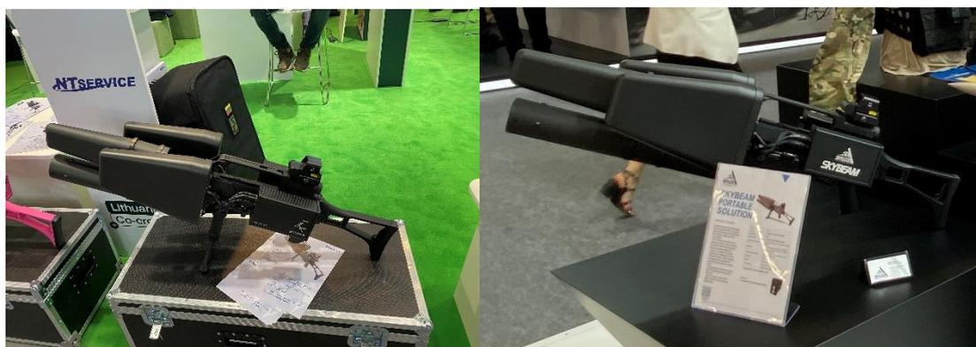
左写真はリトアニアの NT Service 社の SKY WIPER アンチドローンガン、右写真はイスラエルの AVION 社の SKYBEAM アンチドローンガンです。他の製品も同様ですが、妨害をするのはドローンの制御周波数、ドローンからのダウンリンク周波数及びドローンの位置把握に利用する GPS 等の周波数です。有効射程はガンタイプのものは 5km を超えていました。対象ドローンは軍用の特殊ドローンではなく一般の市販ドローンでそれを使った軍事目的やテロ攻撃目的に対処するためです。
