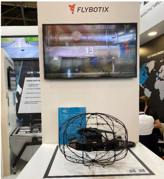
左の写真は狭い場所や様々な障害物が存在する場所で行動するためのドローンで、ぶつかっても良いように網が全体を覆っています。軍事用にも当然使えますが、主に構造物内部の配管設備の点検などに使われているのが最も多いようでした。軍事用に建物内部の偵察用として限定して作るというよりも、民間の明確な用途に使用するために作ったものが、軍事用にも同様の条件下で使用できると言うことだと思います。
