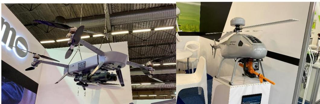
左上写真はノルウェーの Nammo 社の 72mm ロケットランチャー 2 本を携行した GRIFF 社製のドローンで現在は 20 分の飛行時間ですが、来年中にはハイブリッド機関を搭載して 2 時間の飛行時間を実現するとのことでした。搭載している Nammo 社の 72mm ロケットランチャーは対戦車兵器でも紹介しますが、後方へのブラストが少ないのでこのような小型ドローンへの搭載が可能なのかも知れません。写真右はイスラエルの Smart Shooter 社の狙撃システム搭載の銃を同国 STEADICOPTER 社の Golden Eagle というドローンに搭載したもので Smart Shooter の射撃統制コンピュータ付の照準器により正確な射撃が可能となっています。
